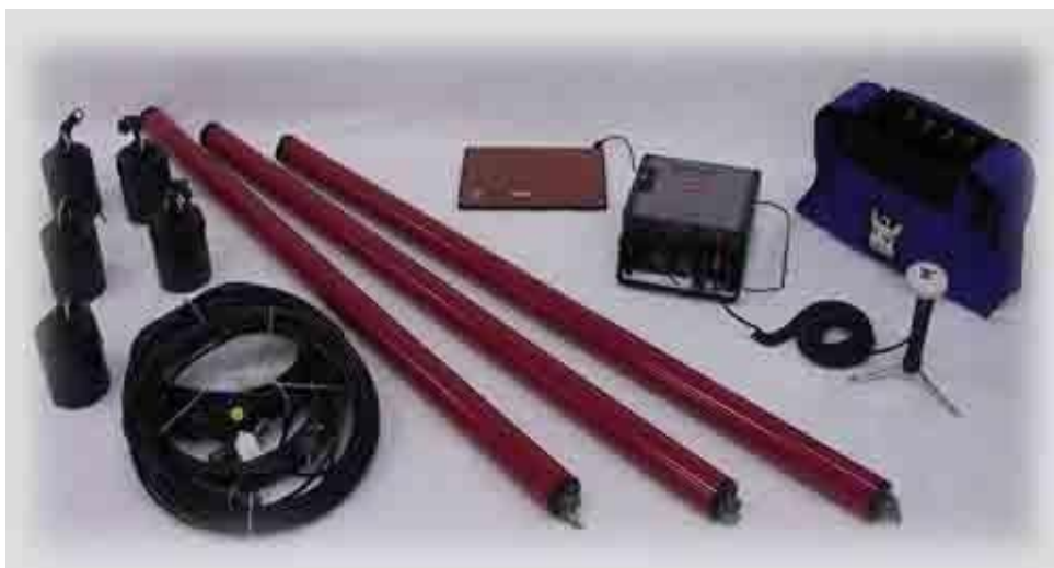
3.2-сурет – Phoenix Geophysics жабдықтар жинағы MTU-5AM КИТ-тің техникалық сипаттамалары 3.1-кестеде көрсетілген
